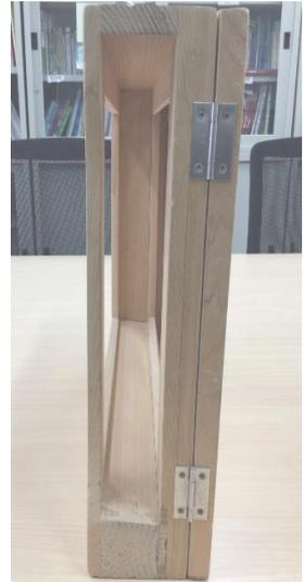
經由木製框架開口（觀賞者的左側）進行圖畫紙張的抽拉，溝槽內部可容納紙張總厚度約3.8公分。
